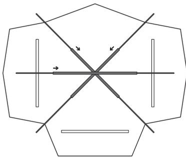
組み立てた2本のポール(グレー)を本体中央のスリーブに通し、本体上でクロスさせます。本体上部にあるスリーブにポール(ブラック)を通します。
